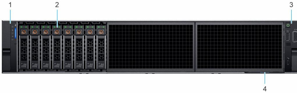
그림 3 . 8개의 2.5" 드라이브 시스템의 전면
